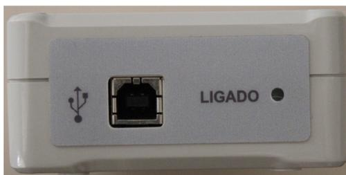
Entrada do cabo USB – Conector padrão USB onde é conectado o cabo responsável pela comunicação entre o Cardiofit USB e o computador e também pela alimentação do eletrocardiógrafo.
