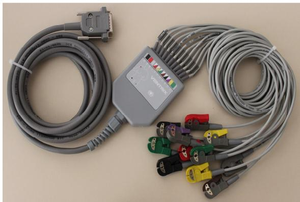
Cabo de Paciente 11 vias (ECG) – Cabo responsável pela condução do sinal elétrico do músculo cardíaco do paciente ao Cardiofit. Ele apresenta um conector macho padrão DB15 para conexão ao Cardiofit USB e 11 terminações padrão Neo Pinch para fixação aos eletrodos colocados no paciente.
